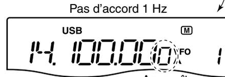
Tourner le [VERNIER] pour modifier la fréquence par pas de 1 Hz.
