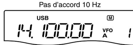
Tourner le [VERNIER] pour modifier la fréquence par pas de 10 Hz.
