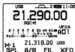
Pour inverser les fréquences d'émission et de réception, appuyer sur [F-2 A/B] (M-1) pour échanger les réglages des VFO A et B.
