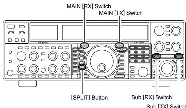
En mode “split”, le registre du (VFO-A) principal est utilisé en réception, alors que le registre du (VFO-B) secondaire est utilisé en émission. Si vous appuyer sur le commutateur [SPLIT] une fois de plus, le mode “split” est annulé.
