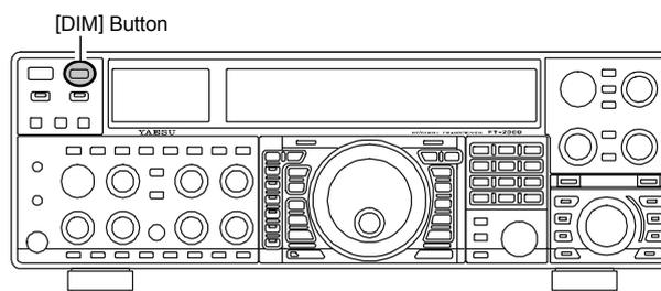
Vous pouvez également personnaliser le degré de réduction de luminosité à appliquer en appuyant sur le commutateur [DIM] et des niveaux différents de luminosité peuvent être utilisés sur différentes zones de la face avant. Le menu "008 diSP DIM MTR" règle le niveau de luminosité de l'indicateur analogique alors que le menu "009 diSP DIM VFD" règle les niveaux de luminosité de l'affichage de la fréquence principale (ces réglages sont effectifs uniquement quand le commutateur [DIM] est appuyé).
