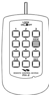
3. Appuyer sur une des touches numérotées de **[1]** à **[5]** pour sélectionner le registre mémoire qui sera utilisé. Si vous n'appuyez pas sur le **PTT** (voir point suivant) dans un délai de cinq secondes, le processus de mémorisation est annulé.
