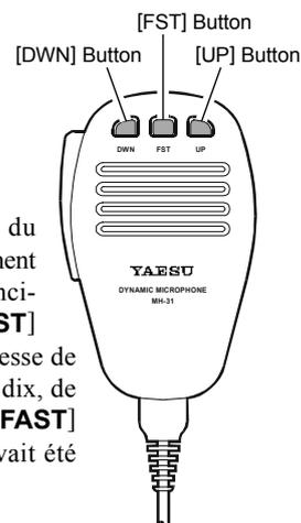
Les commutateurs [UP]/[DWN] du microphone utilisent le pas d'incrément courant du bouton de réglage principal; de plus, quand la touche [FAST] du microphone est appuyée, la vitesse de réglage augmente d'un facteur de dix, de la même manière que si la touche [FAST] de la face avant du transceiver avait été appuyée.
