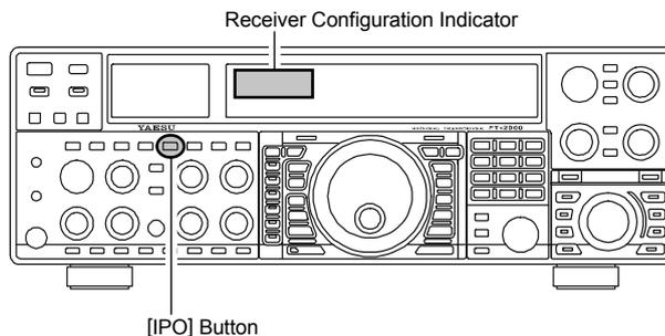
Le préampli HF sélectionné est indiqué sur la colonne IPO de l'indicateur de configuration du récepteur sur l'afficheur.
