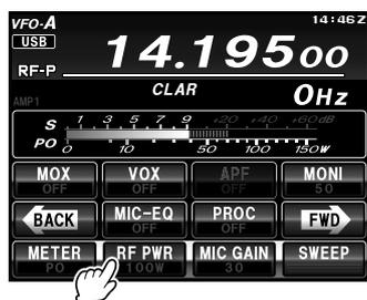
5. Réglez le gain de l'amplificateur de microphone pour adapté le micro à votre niveau de voix: Touchez plusieurs fois **[METER]** sur l'écran LCD pour sélectionner "ALC". Appuyez sur l'interrupteur **PTT** et maintenez-le enfoncé puis parlez dans le micro avec un niveau de voix normal. **En mode SSB**, touchez **[MIC GAIN]** puis réglez le bouton **MULTI** de sorte que l'indicateur ALC reste dans la zone ALC de l'indicateur (jusqu'à une déviation de demi-échelle) sur les crêtes vocales.
