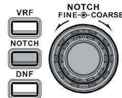
Le mode d'action du filtre Notch FI est montré à la figure "A," où les effets de la rotation du bouton [**NOTCH**] sont présentés. A la figure "B" vous pouvez voir l'effet "crevasse" du filtre Notch FI quand vous tournez le bouton [**NOTCH**] pour éliminer des interférences entrantes.
