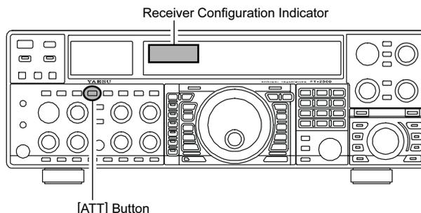
2. Pour restorer la force totale du signal à travers le circuit d'atténuation, appuyer sur le bouton [ATT] pour remettre l'indication ATT sur "OFF".
