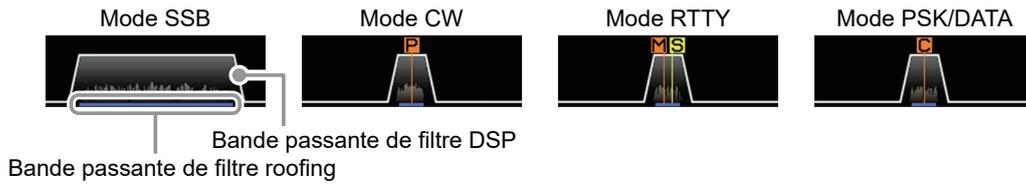
Touchez l'afficheur du filtre pour afficher et vérifier la valeur de réglage de la dernière fonction utilisée parmi SHIFT, WIDTH, NOTCH, CONTOUR et APF. Le réglage peut être modifié en tournant le bouton de la fonction active.
