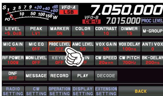
4. Touchez la zone des instruments de mesure sur l'afficheur pour sélectionner l'indicateur "COMP". L'indicateur de transmission devient l'indicateur "COMP".
